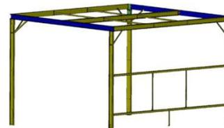
**Etape 9:** Option si jumelage de plusieurs modules. Effectuer l'assemblage des structures du ou des modules complémentaires suivant les étapes précédentes et les lier ensemble avec les vis M12X140 (N°23)•. Le module complémentaire est fixé au sol après l'assemblage avec le 1<sup>er</sup> module et la pose des différents taquets à leur jonction.
